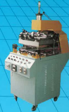
三邊自動摺邊機 MODEL: GT-4050 # 將 PVC 膠片摺邊， 適用於文具、禮品等包裝。
